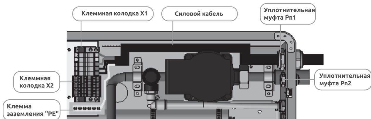
**Рисунок 10 – Прокладка силового питающего кабеля внутри котла (прибор повернут в вертикальный вид).**
