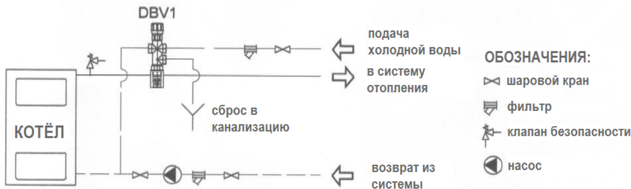
Рис.3 Схема системы с двухходовым клапаном безопасности DBV1.
